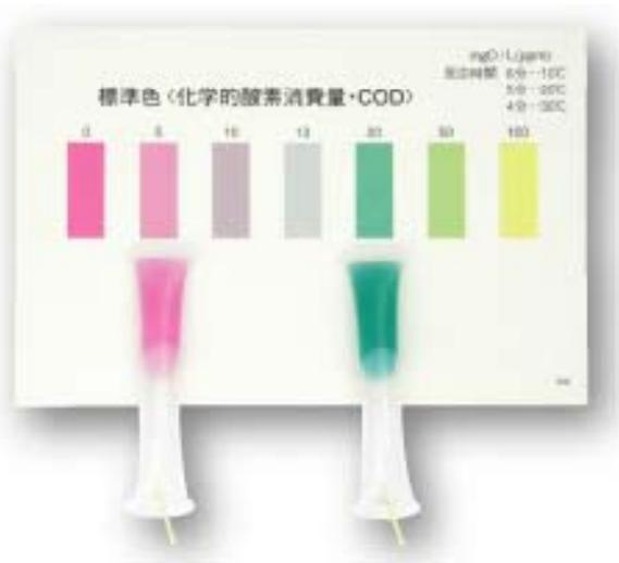
パックテストの、透明なチューブの中に、薬品が入っています。このチューブの中に水を入れると薬が反応して、水の色が変わります。その色を目安にして水質を調べます。
